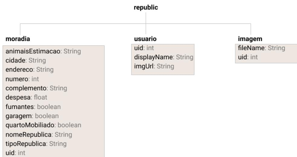
Figura 11 – Estrutura JSON representada graficamente em forma de árvore
